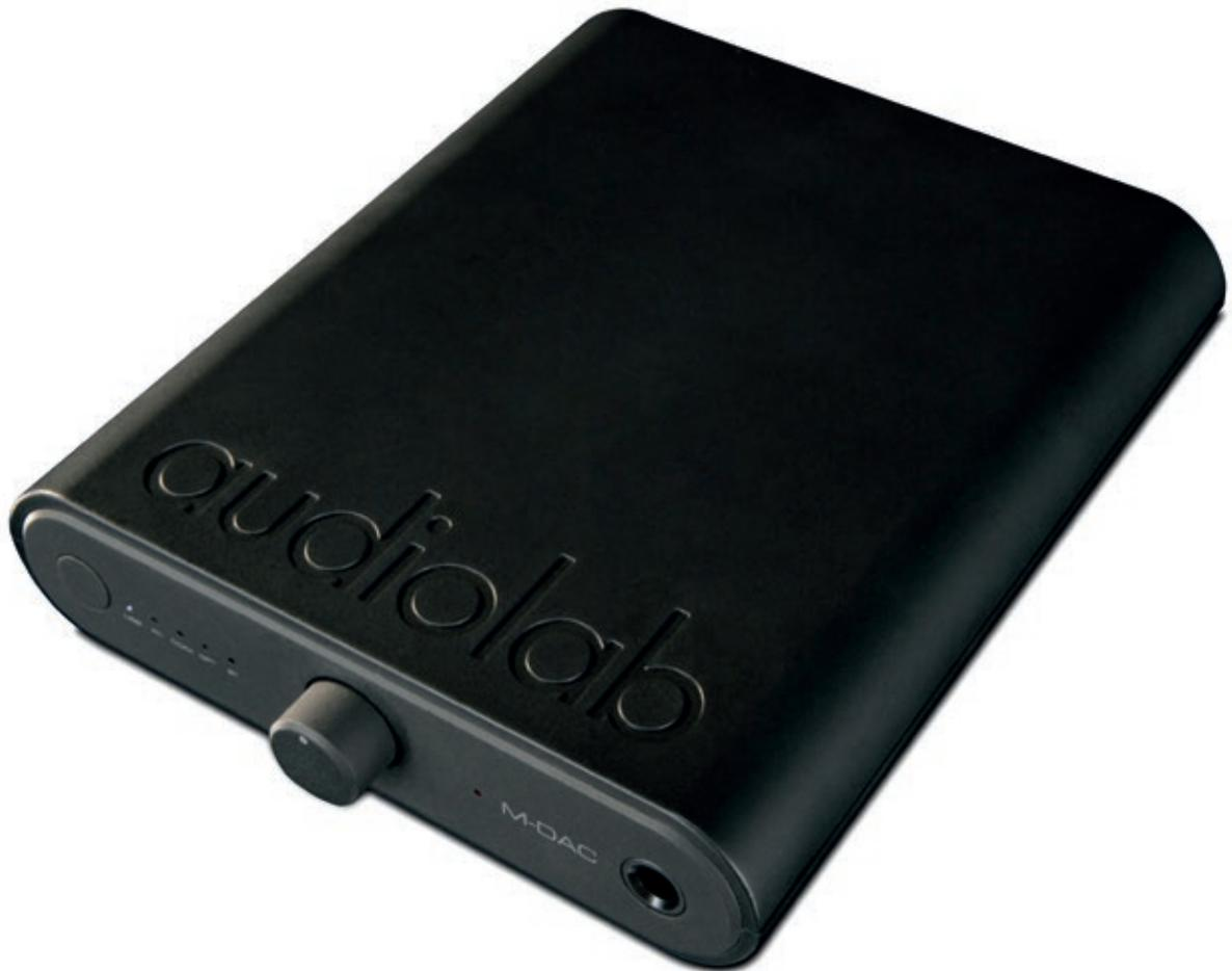
sortierten und offenen Klangcharakter des kleinen Audiolab wider. Am angeschlossenen Kopfhörer haben wir im Akkubetrieb eine Ausgangsleistung von 2 x 25 mW an 38 Ohm gemessen.
