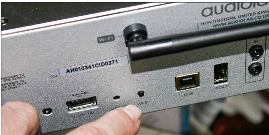
**Das Anschlussfeld des Audiolab 9000N verrät symmetrische wie unsymmetrische Analogausgänge, LAN, Digitalanschlüsse inklusive USB - und eine WPS-Taste für einfache WLAN-Anbindung.**
