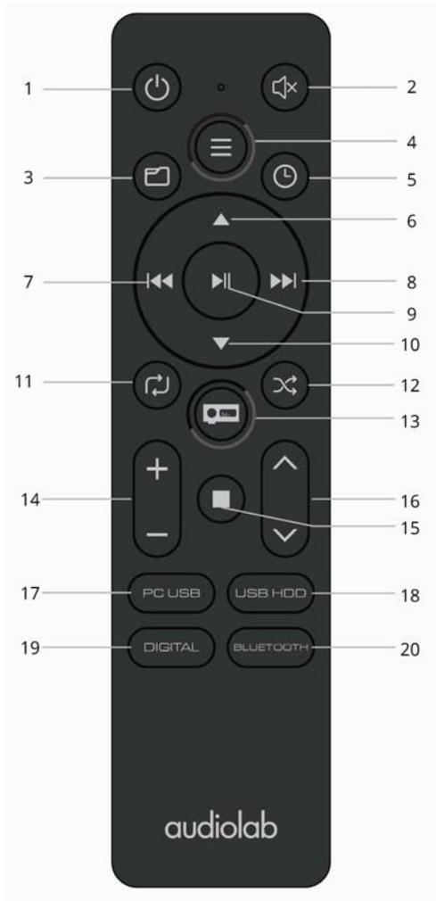
1. **Standby** Drücken, um das Gerät in oder aus dem Standby Modus zu bringen.
