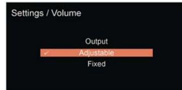
Wird die Einstellung ADJUSTABLE gewählt, dann kann der Pegel des analogen Ausgangs mittels des Lautstärkereglers des 9000N eingestellt werden. Dies ist erforderlich, wenn der 9000N direkt an einen Endverstärker angeschlossen wird.
